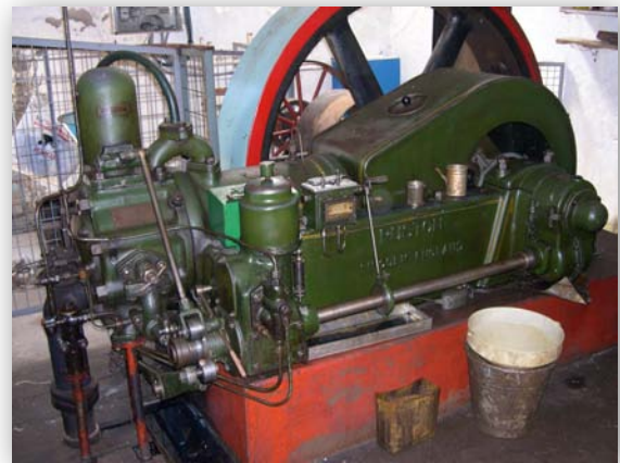
Motor ruston de 40 CV. Pozo Las Vegas
