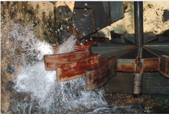
Rodezno de un molino de agua
